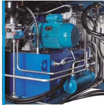
Unidade Hidráulica com bomba de deslocamento variável, visando maior eficiência energética. O sistema inclui acumulador e válvula direcional proporcional para controle preciso dos movimentos de transferência, abertura e fechamento do molde e acionamento do pino de sopro.
