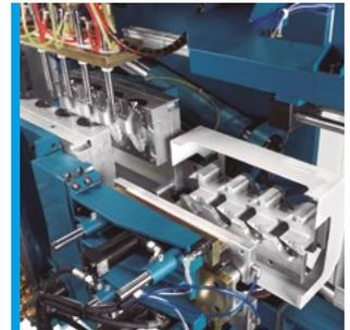
Fechamento com opção de rebarbação hidráulica automática e extração lateral de peças.
